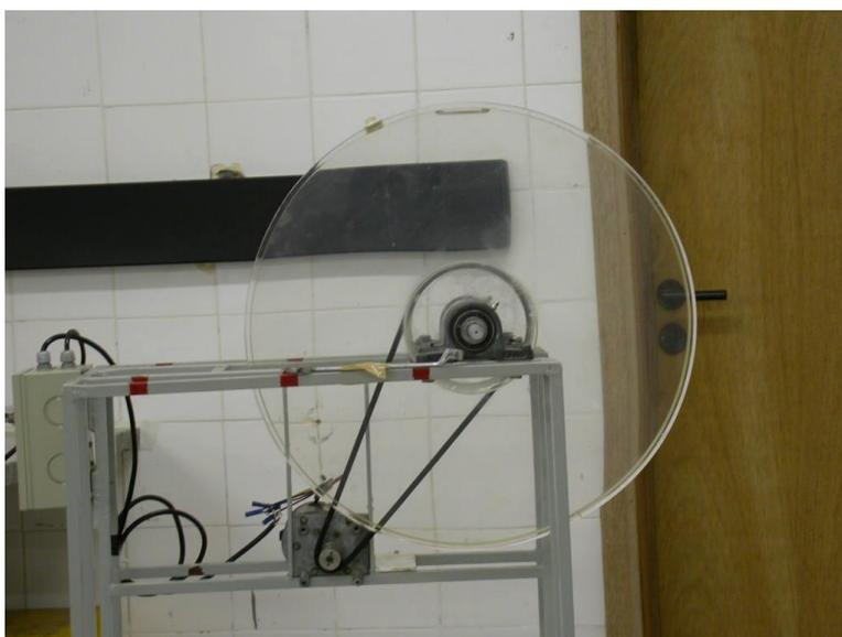
Figura 1: Floculador de disco accionado por un motor.
