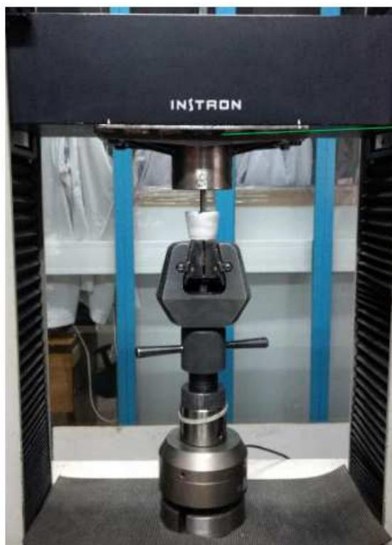
Figura 1: Equipo empleado en el trefilado de las barras.
