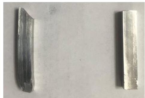
Figura 5 – Probeta deformada y sin deformar.
