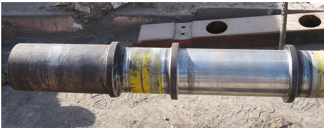
Figura 3: Sectores del cojinete 3 a la derecha de la falla.
