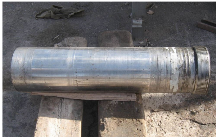
Figura 2: Sectores del cojinete 3 a la izquierda de la falla.
