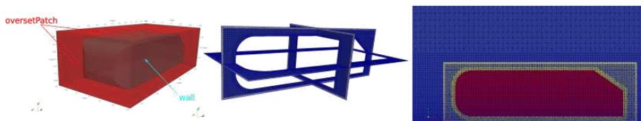
Figura 4: Condiciones de borde, tipos de celdas y solape entre mallas
