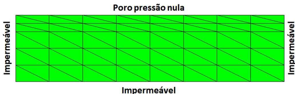
Figura 5: Malha e condições de contorno hidráulicas.
