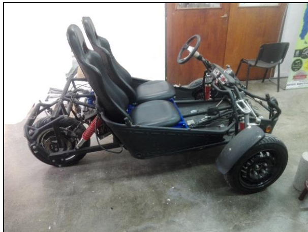
Figura 2 - Vehículo en desarrollo con configuración tadpole.
