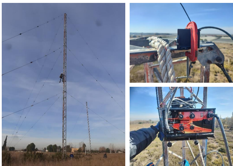
Figura 4: Izq.) Montaje de acelerómetros. Der.) Uniaxial en la cima y triaxial a mitad de altura.
