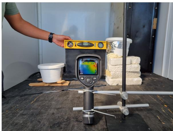
Figura 5: Dispositivo experimental: placa metálica, cámara termográfica y focos térmicos.
