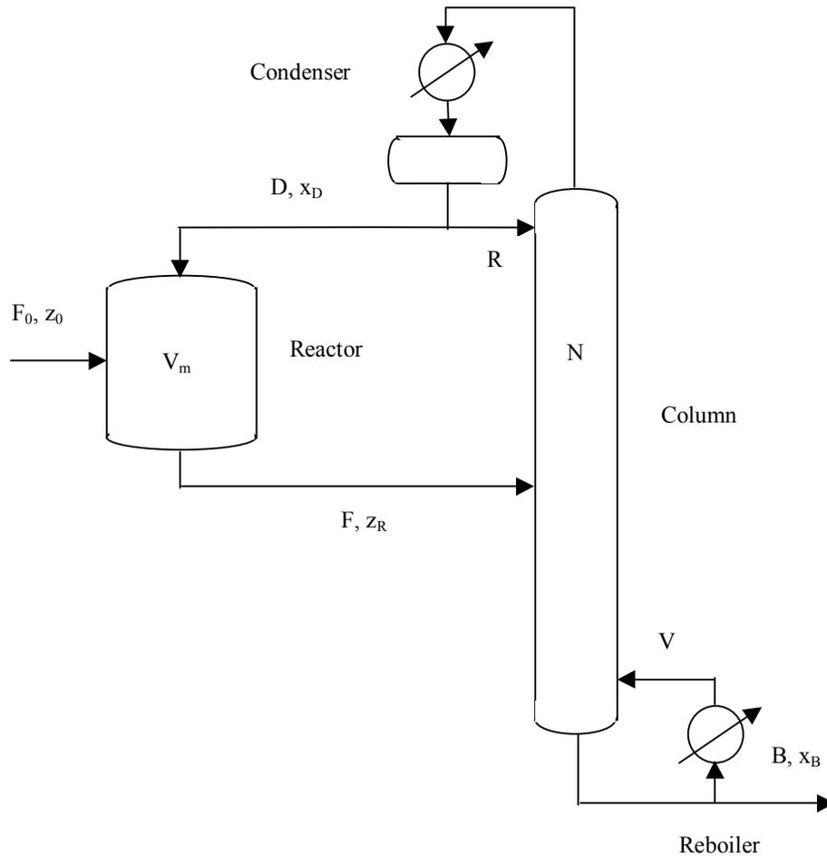
**Fig. 1:** Reactor-Separator-Recycle System
