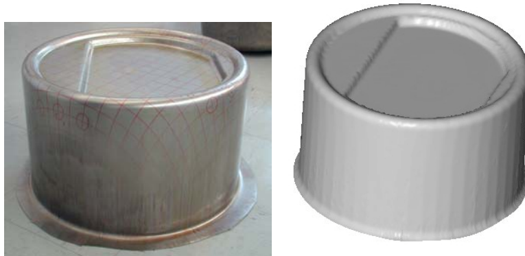
Figura 15 Comparación de las configuraciones geométricas finales de la pieza embutida y de la obtenida por la simulación numérica.
