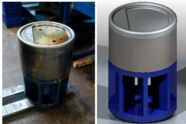
Figura 4: Fotografía del punzón y CAD 3D del mismo.
