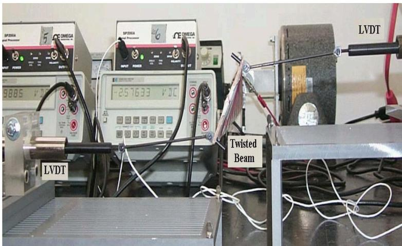
Figura 4. Foto del montaje Experimental. En el se observa la viga torsionada.
