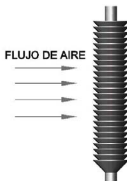
Figura 1: Tubo con aletas inclinadas en un ángulo \gamma con respecto al eje axial.
